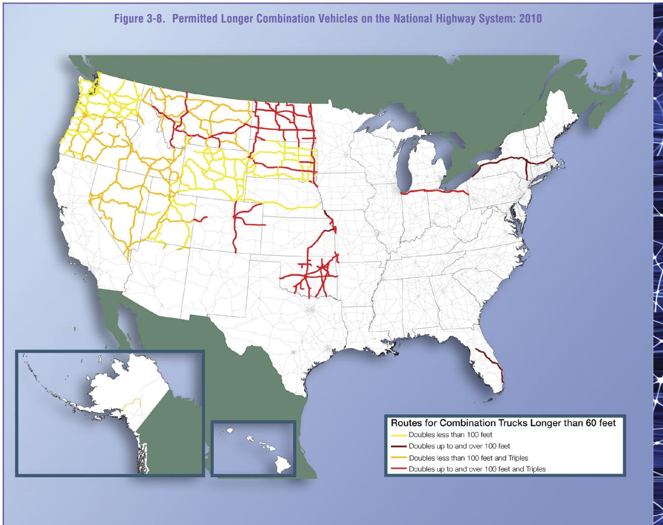
**FIGURE 3-8. PERMITTED LONGER COMBINATION VEHICLES ON THE NATIONAL HIGHWAY SYSTEM: 2010**
